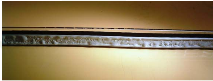
Рисунок 2: Образцы после УФ воздействия – 1,283 часа
